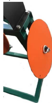
Immagine 2: Posizione della flangia estratta a fine ciclo per scarico
