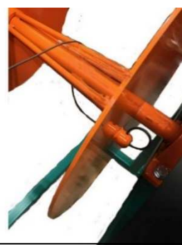
Photo 1 - Exemple du dispositif de blocage du fil début du cycle
