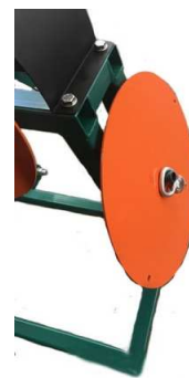
Photo 2 - Position de la bride retirée à la fin du cycle pour déchargement
