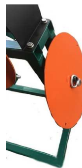
Fotografía 2 – Posición de la brida extraída al fin del ciclo para descarga
