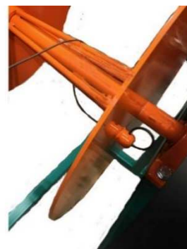
Fotografía 1 – Ejemplo de dispositivo de bloqueo del hilo al comienzo del ciclo
