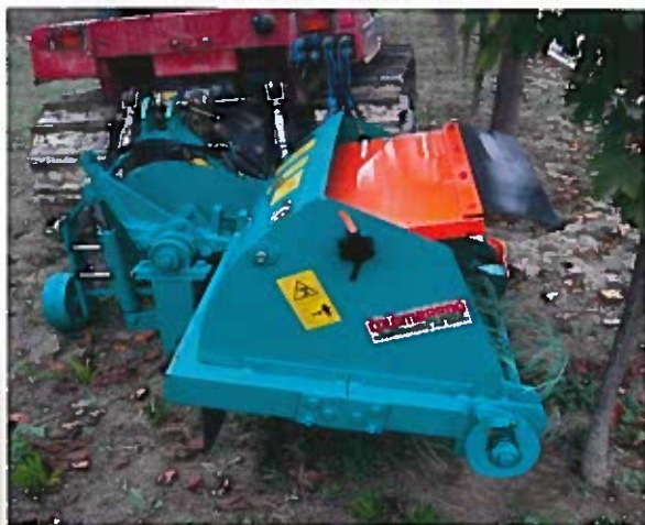
Settore spollonante con angolazione longitudinale regolabile
