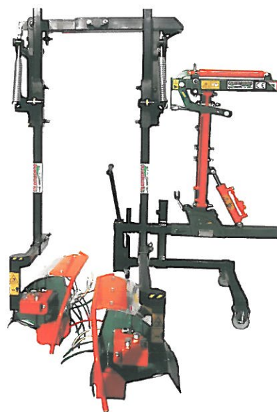
SPOLLONATRICE MOD. ROTOFLEX IN VERSIONE TUNNEL, SU TELAIO CIMATRICE CON SUPPORTO SCAVALLANTE E FLAGELLI TONDI IN NYLON.
